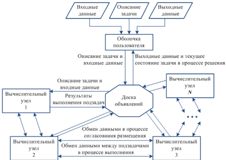
Рис. 1. Архитектура облачного сервиса
